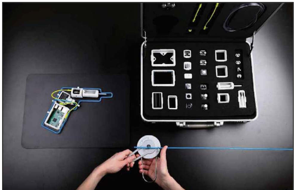
Der Baukasten mit den vielen Komponenten. Der blaue biegsame Draht gibt der jeweiligen Erfindung ihre Form.
